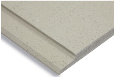
Homogene Gipsfaserplatte in den Dicken 18 und 23 mm, Format 600x1200 mm mit eingefrästem 35 mm breitem Stufenfalz. Element Typ GF-W1-C1, EPS Verbundelement Typ GF-W1-C1 mit Polystyrol, WF Verbundelement Typ GF-W1-C1 mit Weichfaser
