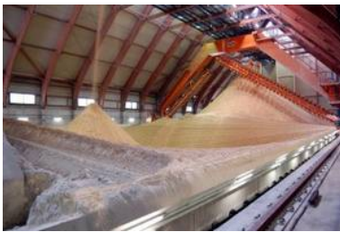
Gips aus Braunkohlekraftwerk
