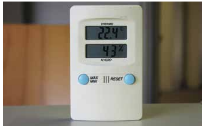
Bild 10: Thermo- und Hygrometer zur Messung von Temperatur und relativer Luftfeuchtigkeit.
